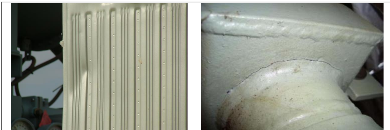
Obrázek 10 Stopy po nárazu ukazující na možné poškození transformátoru po jeho odeslání
